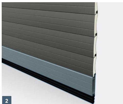
2 Nedre profil – förstärkningsprofil (höjd: 115 mm) i aluminium, i standardutförande lackad i samma färg som portens gardin.
