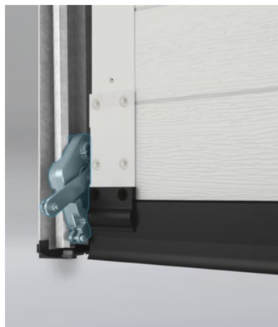
Säkerhetsbromsen förhindrar att bladet faller i händelse av kablageskador
