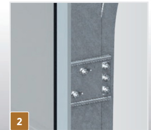
2 Spåren fästs vid öppningsramen med skruvar
